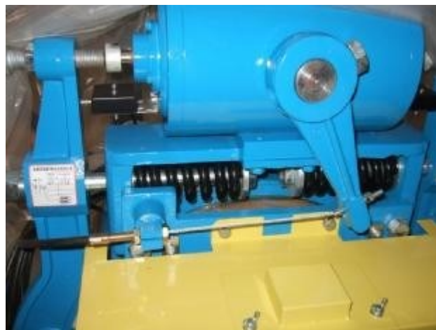
图（1） LTM 鼓式主机远程松闸局部实物照片图
